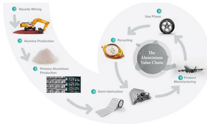
Figura 17. Fasi della produzione di alluminio primario e secondario. Fonte: http://www.alueurope.eu/sustainability/life-cycle-assessment/ .
