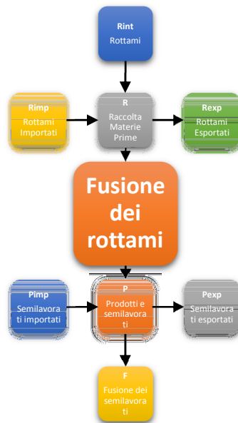
Figura 10. Principali tipologie di flussi nella fusione secondaria dei metalli ferrosi e non ferrosi.
